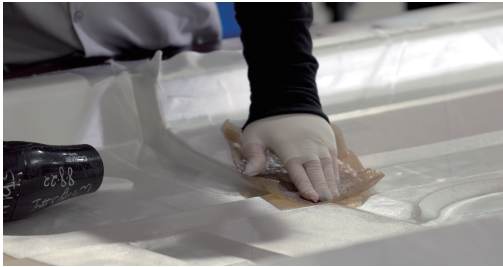
從疊層開始的飛機生產各階段
