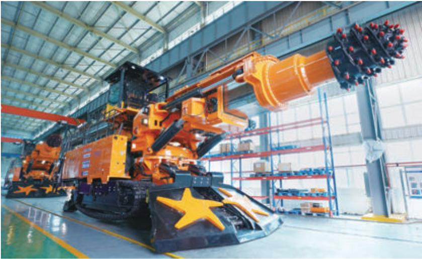
● 中国中铁工业研制的CRT450悬臂掘进机，是世界最大的纵轴悬臂掘进机，出口韩国用于下穿隧道建设
