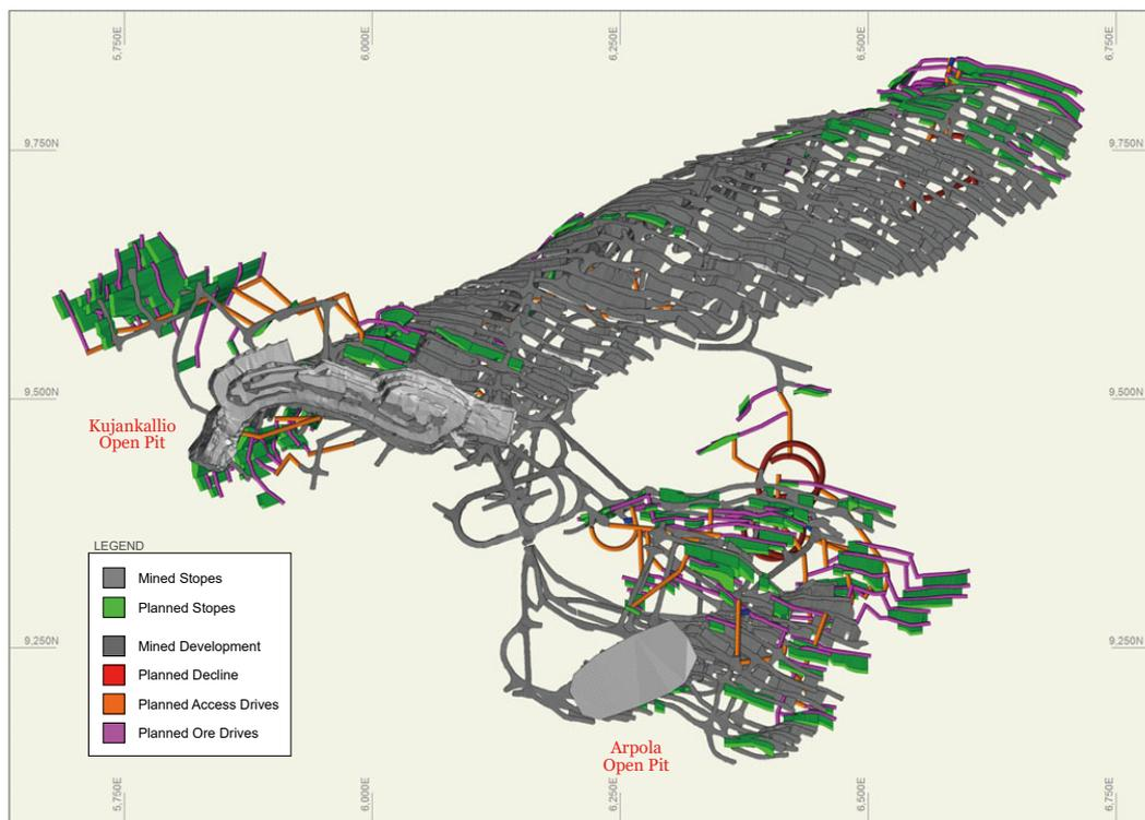
**Figure 2 – Jokisivu Mine Design Plan View.**
