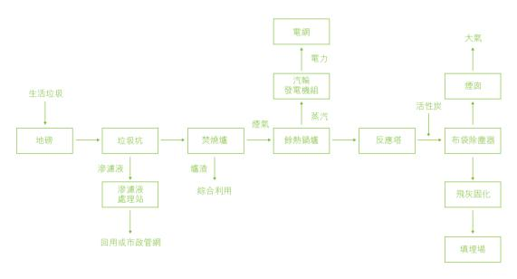
垃圾焚燒發電系統的核心設備是焚燒爐,公司主要使用自主研發的三驅動逆推式爐排爐,該種焚燒爐具有獨特的一體式三段設計,乾燥、燃燒、燃燼段均配置獨立驅動機構,可靈活根據燃燒工況調整各段的運行速度,以 更好地控制火床分佈,使得灰渣熱灼減率更低。
