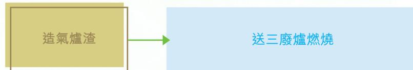
有別於使用天然氣為原材料的尿素生產商，我們使用煤炭進行尿素生產，因此生產過程中會產生大量的廢渣。我們將產生的廢渣送至三廢爐燃燒，經過燃燒後，部分廢渣可以作為鍋爐燃料進行循環使用，其他部分廢渣經過處理後可製成新型建築材料，出售給其他公司。
