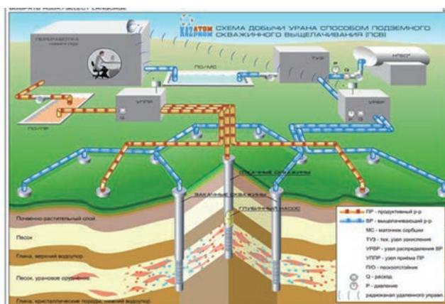
在中門庫杜克鈾礦，地浸溶液透過現場加工廠加工成黃餅(一種含鈾濃縮物的粉狀物)。在扎爾巴克鈾礦的試生產期間，浸出液首先透過現場吸附廠加工成富鈾樹脂，隨後運到中門庫杜克鈾礦的加工廠加工成黃餅。
