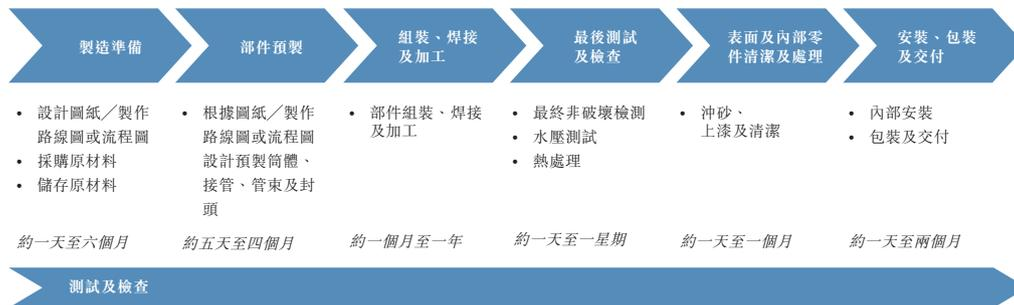
根據弗若斯特沙利文報告，傳統壓力設備通常於高壓高溫的環境下工作，因此傳統壓力設備對密封度及堅固度有嚴格標準及要求，傳統壓力設備的製造過程必須保證生產的安全及高質產品。因此，為增強我們強大的質量控制及管理的能力，並滿足若干行業客戶的特定要求，我們維持一支質量控制團隊，對每個製造步驟進行檢查，以確保傳統壓力設備的質量。此外，我們亦進行標準的非破壞性測試、水壓測試及全面檢查。
