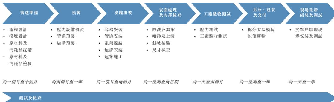
我們按技術團隊的模塊設計嚴格預製模塊化壓力設備，預製部分不僅包括部件，亦包括模塊化壓力設備的結構。我們亦會進行熱處理、水壓測試及標準非破壞檢測，確保模塊化壓力設備的質量。對於中小型工藝模塊／橈塊，我們將在生產地點組裝及集成所有模塊組件，檢查後將運送予客戶。對於大型工藝模塊／橈塊及模塊化工廠，我們將於生產地點預先組裝工藝模塊／橈塊及模塊化工廠，以測試其功能及質量。其後，我們會拆分大型工藝模塊／橈塊或模塊化工廠以簡化運輸，並於客戶地點重新組裝及調試。對於海外客戶，我們通常在客戶場所分包進行工藝模塊／橈塊及模塊化工廠的重新組裝及調試。
