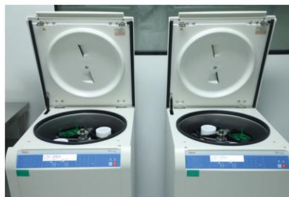
*Centrifuges for cell isolation*
